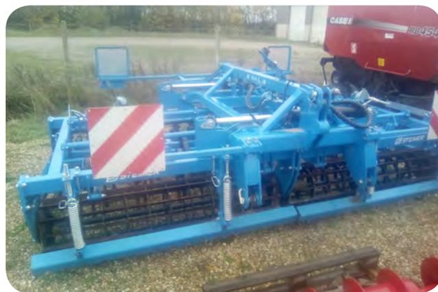
EWA offre un bon compromis entre châssis robuste et poids moyen de la machine. Celui-ci varie entre 1250kg et 3990kg selon le modèle et les options choisies. L'effort de traction nécessaire est donc limité et quasi identique à la version EWA classique.
