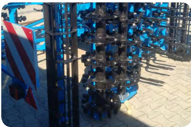
EWA XL effectue le travail et remplace une herse rotative notamment pour les sols légers. La puissance minimale nécessaire est donc peu importante face au poids de la machine (200 pour 6m semi-porté repliable - 3990kg), ce qui occasionne une moindre consommation de carburant.
