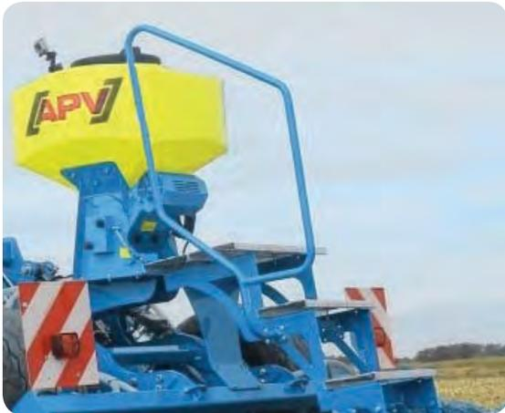
Un support de fixation, une plateforme ainsi qu'une échelle pour semoir APV sont également disponibles en options.
