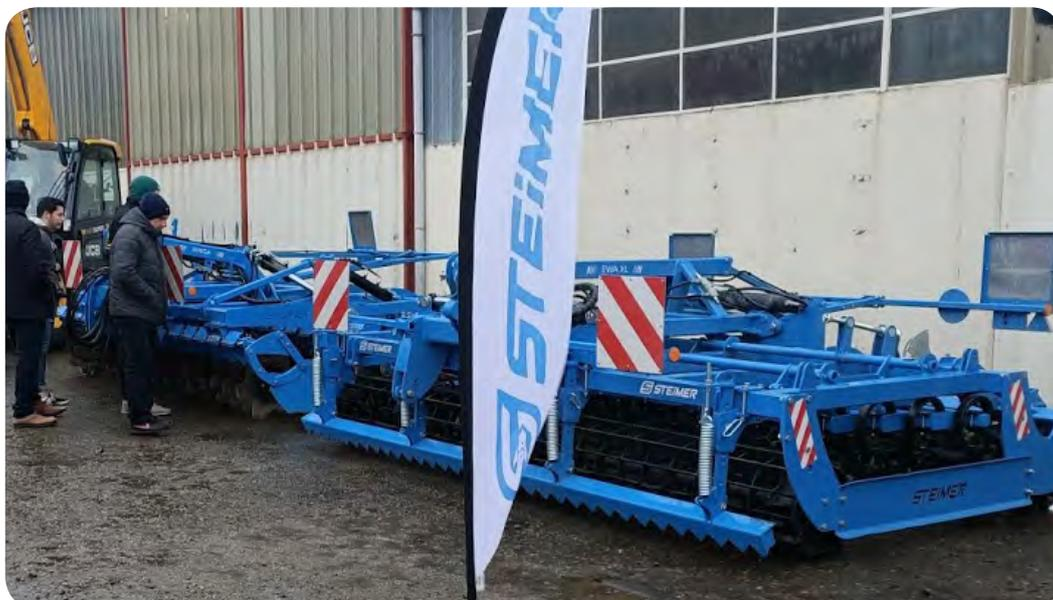
Le combiné EWA offre un excellent débit de chantier. En effet, avec la vitesse, l'impact des dents est d'autant plus important, ce qui brise encore mieux les mottes. Pour une finition optimale, un rouleau fers plats de diamètre 270 mm optionnel à l'arrière du Croskill viendra parfaire le travail du combiné.
