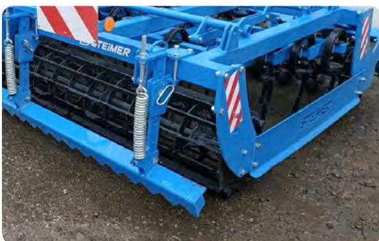
Une planche de nivellement arrière optionnelle située entre les dents (SG et SX) et le rouleaux ou simplement derrière le rouleau Croskill (incompatible avec le fer plat) vient parfaire le travail.
