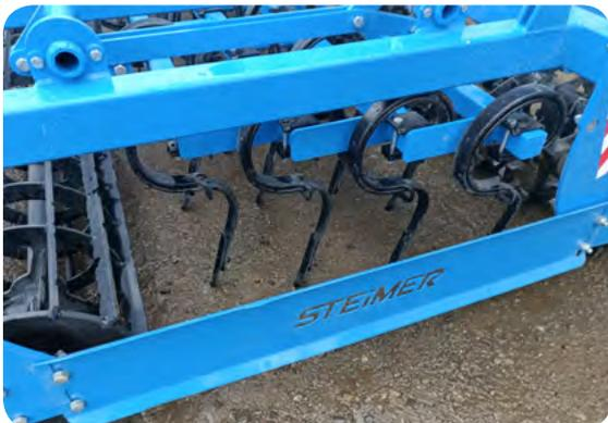
Des éléments complets pour chaque types de dents (SA, SU, SX et SG) peuvent être ajoutés en plus des éléments d'origine.
