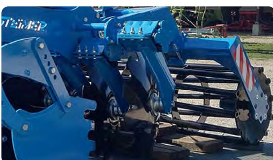
L'ajout d'un rouleau fers plats de diamètre 270mm en supplément derrière le rouleau Croskill garantit le parfait émiettement de la terre. Un rouleau tube avant de diamètre 450 mm peut remplacer le rouleau avant à lames droites.
