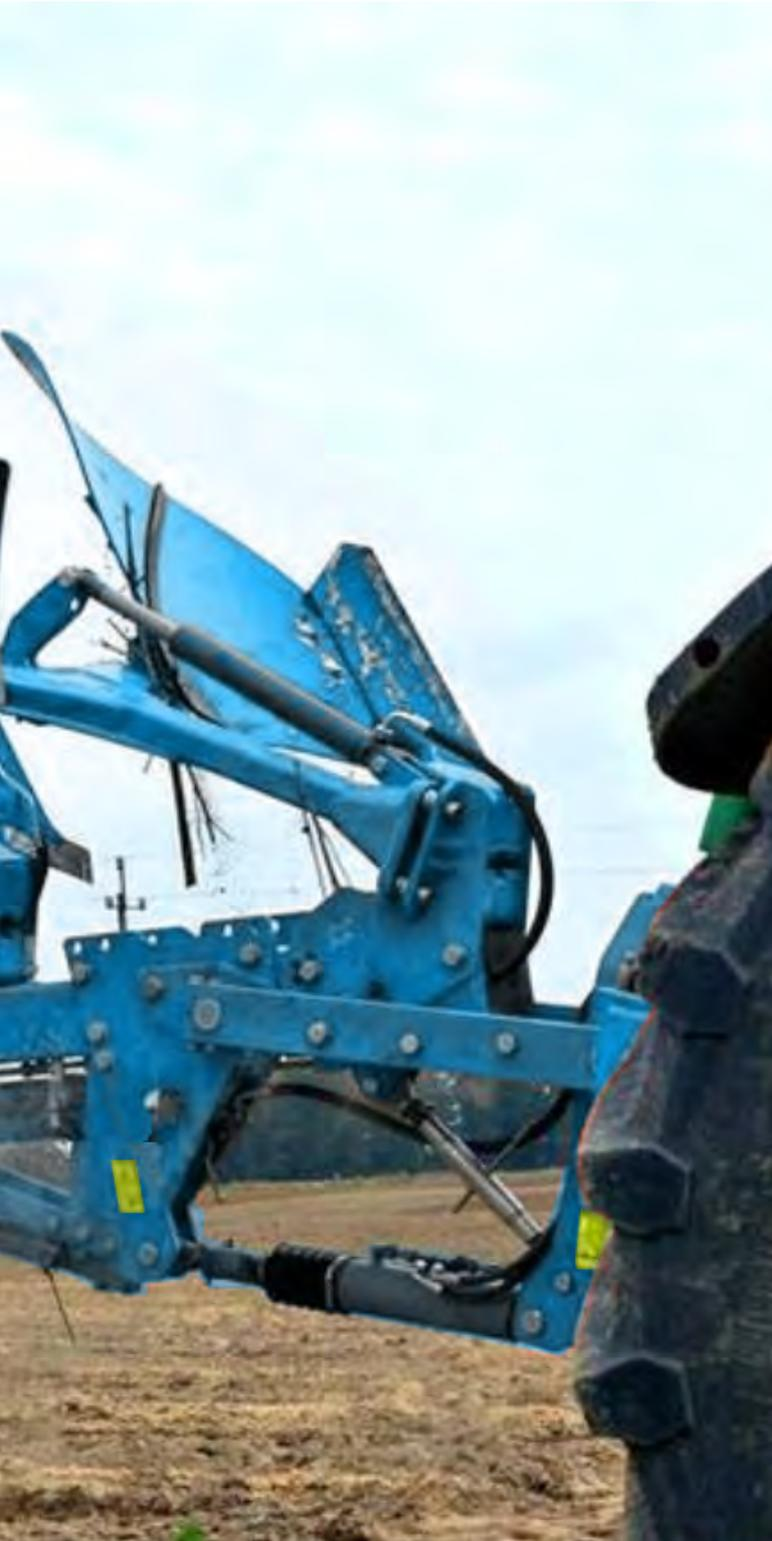
MAGDA HYDRO est une charrue à sécurité hydraulique mais aussi à portée réversible. Le réglage de largeur inter-fers se fait à l'aide d'un système mécanique qui s'adapte aux conditions du sol. La largeur peut alors varier de 38 à 50 cm.
