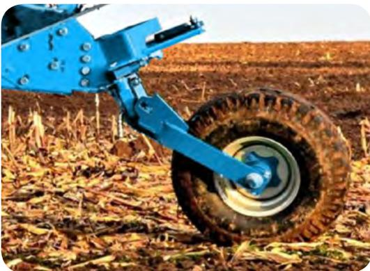
L'ajout d'une roue de profondeur et de transport 10,0/80x12/10PR augmentera la stabilité de la machine sur tous types de terrains. Il permettra également d'avoir un réglage précis de la profondeur de travail de l'outil. Son réglage est mécanique et indépendant diminuant ainsi l'encombrement.
