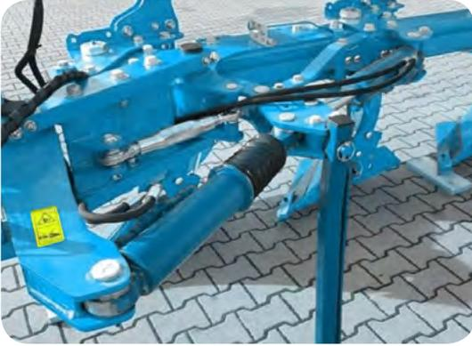
MAGDA HYDRO peut tout d'abord disposer d'un vérin de remise en ligne et d'ajustement hydraulique avec mémoire de travail.
