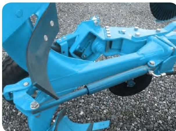
Une manivelle assure le réglage de l'aplomb. Cette manœuvre est facile et très rapide vous garantissant un gain de temps de réglage et de maintenance.
