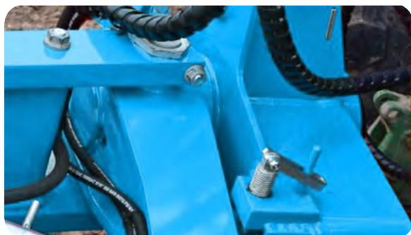
Le réglage de la largeur de travail se fait mécaniquement. Il garantit ainsi une adaptation aux conditions des différents types de sol. La dimension inter-fers peut varier.
