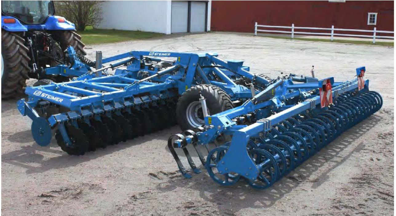
**LENKA** est un outil très bien adapté au déchaumage en conditions difficiles grâce à son essieu central, à son système de suspension hydraulique et à ses 4 vérins de repliage.
