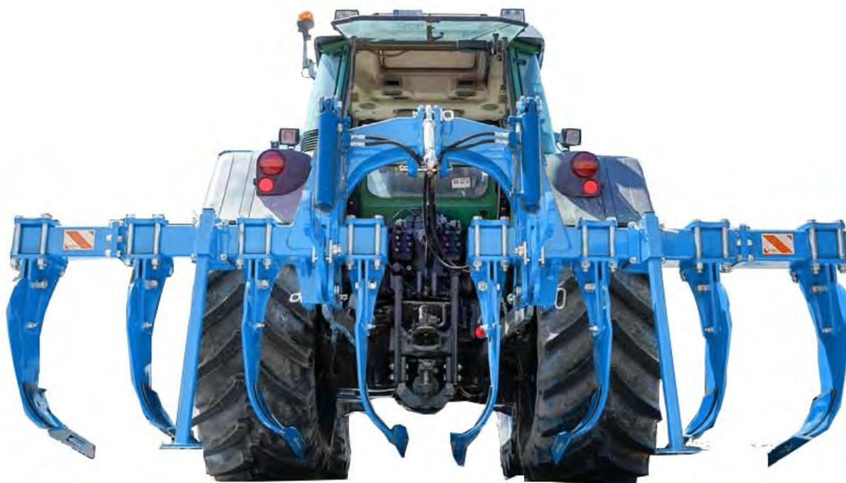
L'ameublisseur **SARA** est doté d'un châssis monopoutre.
