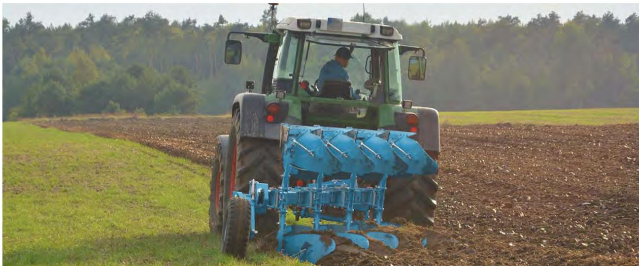
**MAGDA VARIO** permet une manipulation facile de la charrue. Grâce à cette technologie, la machine permet un réglage indépendant et sans à-coups de la largeur de travail, depuis le poste de conduite.
