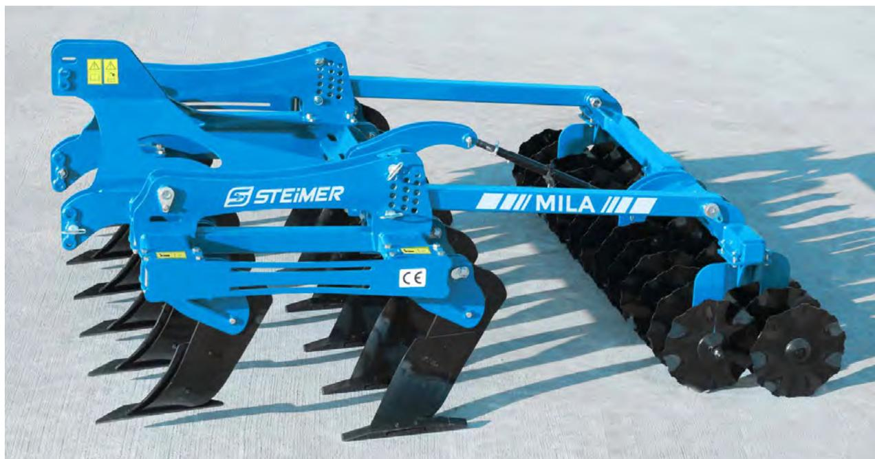
L'ameublisseur **MILA** est une machine complète, qui assurera un ameublissement homogène sur toute la largeur de la machine grâce à deux rangées de dents.
