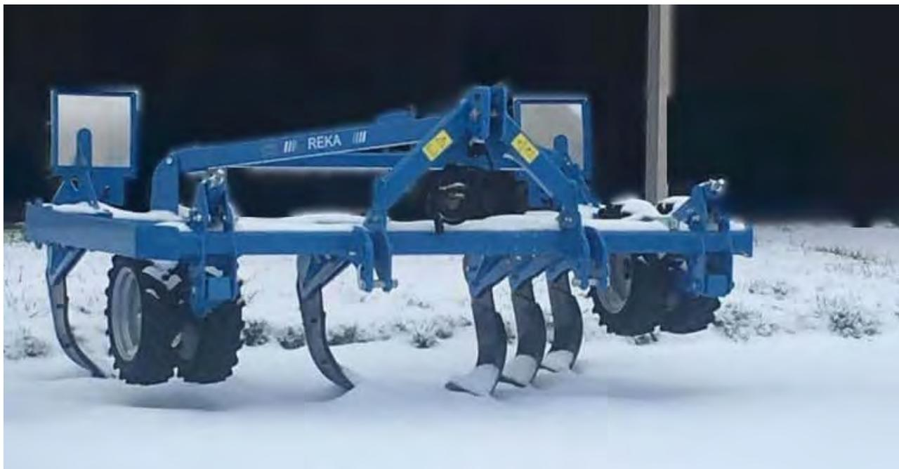
**REKA** est un ameublisseur qui possède un châssis en V, diminuant ainsi considérablement la force de traction et assurant un important flux de débris.
