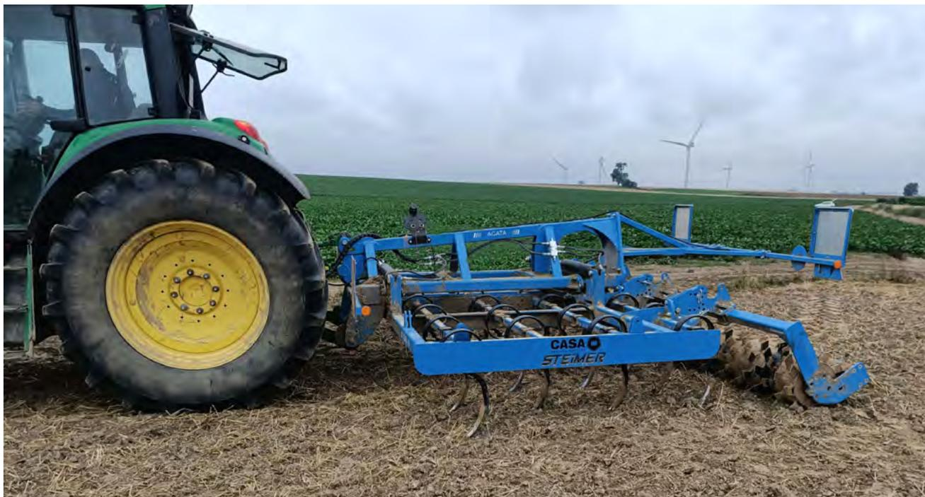
**AGATA** est une machine polyvalente destinée à reprendre un labour, ouvrir les sols pour les cultures de printemps, effectuer un faux semis, enfouir les intercultures et également la matière organique, grâce à une dent de 54 cm de longueur sur laquelle on pourra ajouter une patte d'oie pour les travaux de déchaumage.
