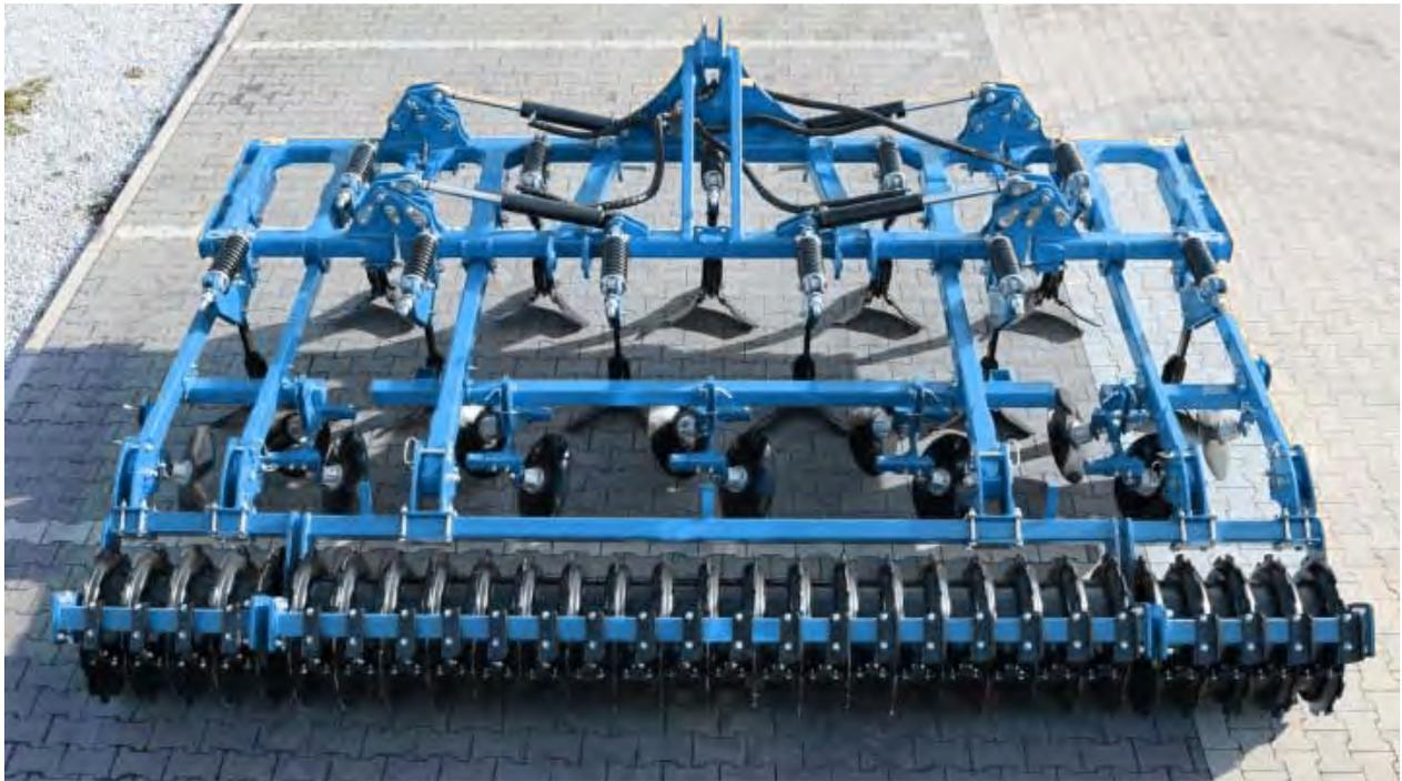
**KLARA** est un cultivateur qui possède deux rangées de dents droites et rigides avec des cœurs à ailettes. Son châssis d'une largeur de 3 à 6 m est compact et requiert ainsi une capacité de levage moins importante.
