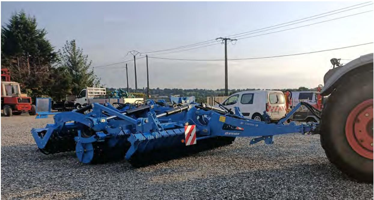
**JOANNA** est un déchaumeur à disques dont les modèles permettent un travail sur des largeurs allant de 3 à 6 m, avec des versions fixes et semi-portées repliables.
