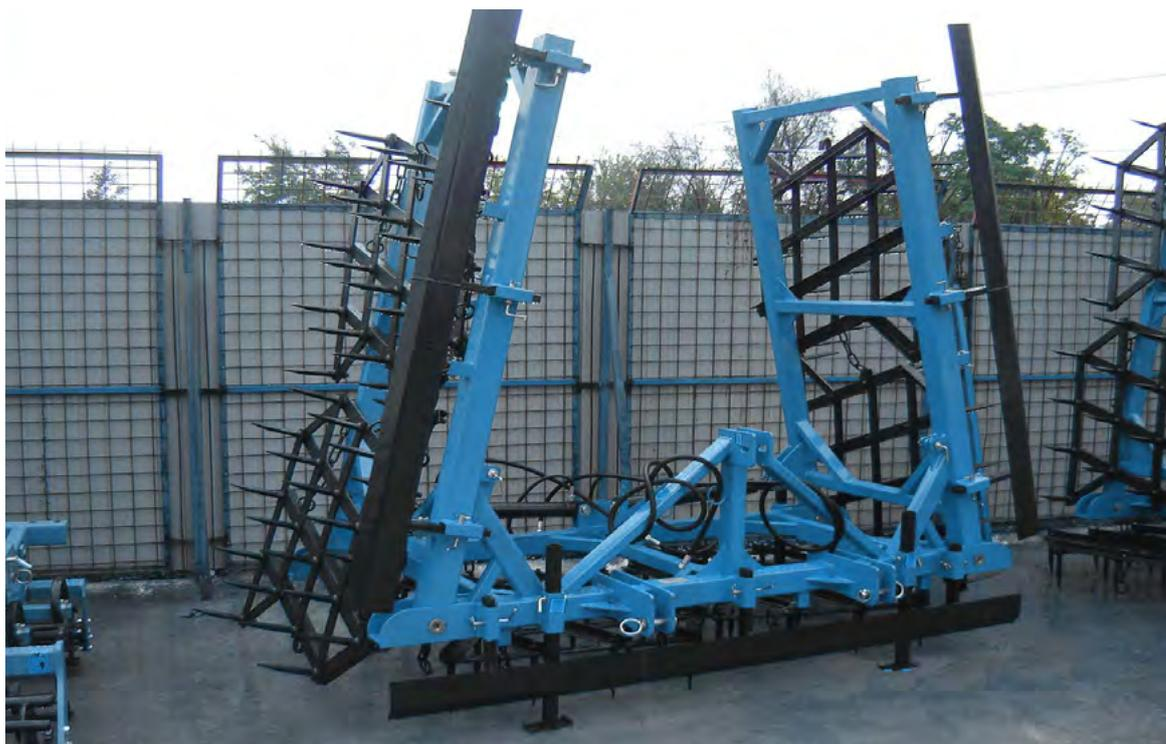
**EMILIA** se caractérise par un châssis à repliage hydraulique ultra robuste 100x100x8 mm, qui assurera à coup sûr une robustesse à toute épreuve.
