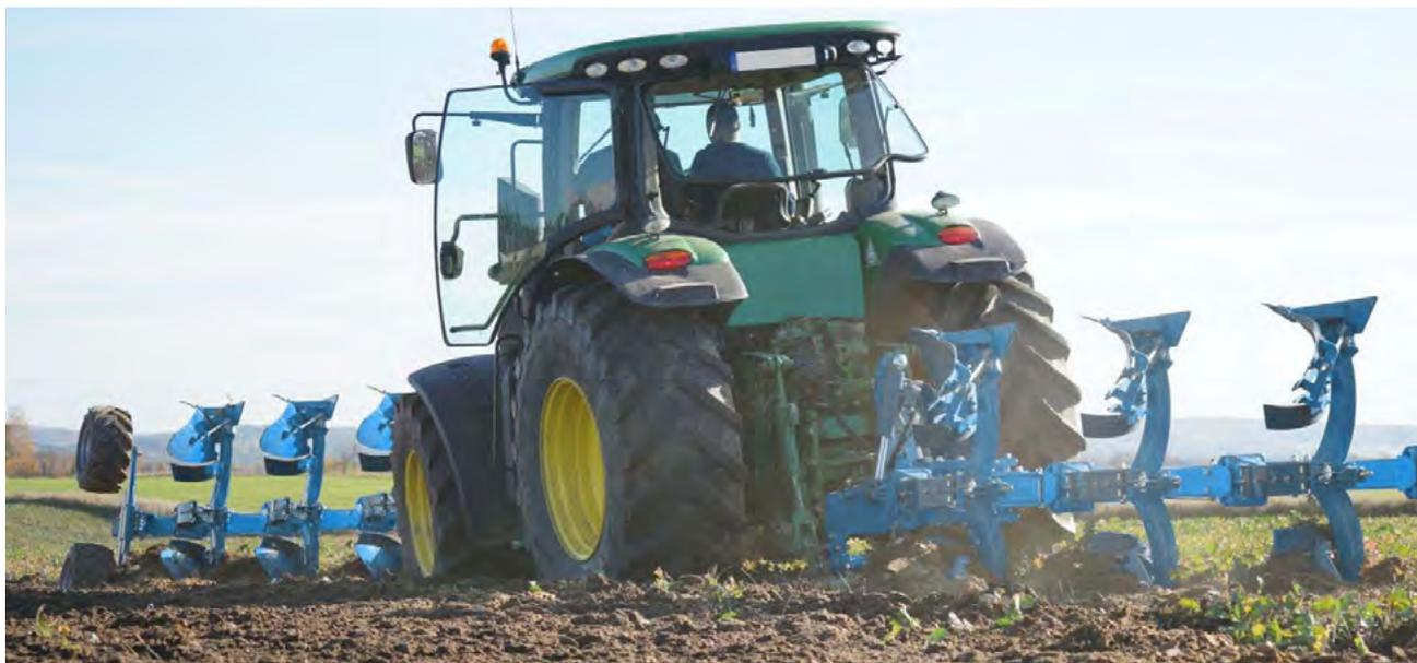
La **charrue MAGDA AVANT** dispose d'éléments similaires autres modèles de la gamme MAGDA. Autrement dit, elle permet de labourer en profondeur grâce à plusieurs coutres conçus en acier haute résistance.
