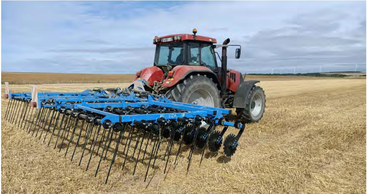
**LIZA** est une herse à paille qui peut servir à des travaux de tous genres : mulch, faux-semis, contrôle des adventives, lutte contre les nuisibles (limaces, souris...), etc. Elle permet un travail sur **6, 7,5 ou 9 m** de large, et dispose d'un repliage hydraulique.
