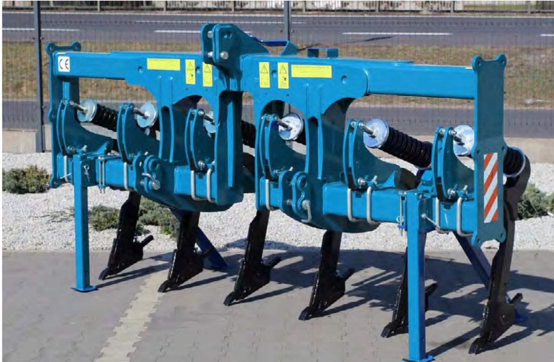
Le fissurateur monobarre **EMA** assure une pénétration même en conditions difficiles grâce à une dent de fissuration de 35 x 70mm étroite et montée sur brides. Elle respecte la structure du sol et évite ainsi la remontée de terre en surface. La fissuration est assurée par deux ressorts qui facilitent la vibration de la dent.
