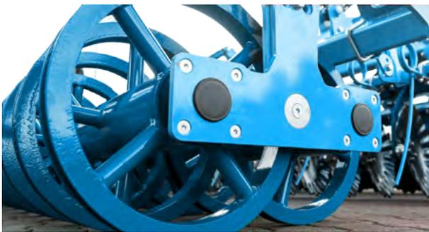
**IXELLA** est un déchaumeur à disques idéalement conçu pour un travail en surface après moisson. Assurant une largeur de chantier égale à 8m ou 10m ainsi qu'une vitesse de 15km/h, cet outil génère un important gain de temps.
