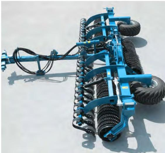
**KASIA** est constitué d'un châssis très robuste ainsi que de rouleaux à repliage hydraulique. Trois types de montages seront possibles suivant les types de sols :
