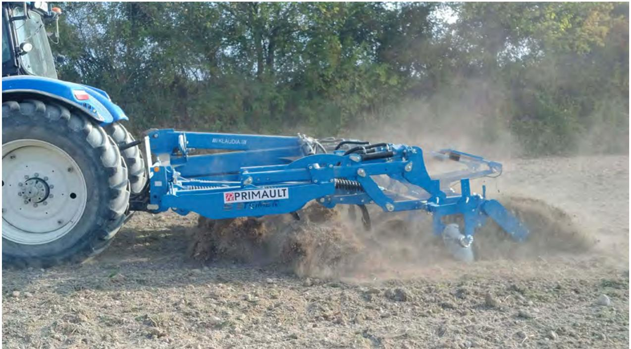
Le déchaumeur **KLAUDIA** est un outil compact et polyvalent. Grâce aux différents socs disponibles, **KLAUDIA** permettra ainsi de réaliser aussi bien un déchaumage superficiel de **5 cm** qu'une fissuration à **30 cm** avec un brassage important et homogène, grâce à ses trois rangées de dents.
