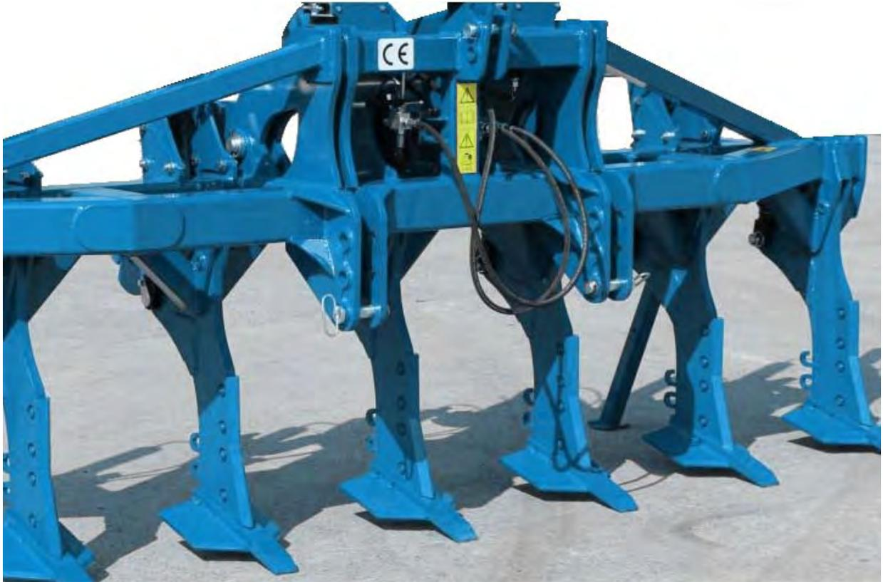
ANIA est une machine à châssis monopoutre, destinée à fissurer et à ameublir le sol.
