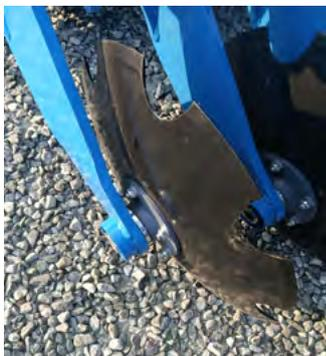
Les disques dentés Ø620 mm, d'épaisseur 6 mm permettent un travail dans les sols les plus durs de par leur forme et la présence d'amortisseurs caoutchouc 50 mm x 210 mm.
