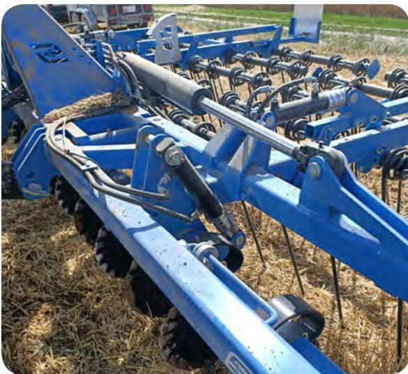
LIZA dispose de l'avantage d'être relativement légère et de ne travailler qu'en superficie. Elle est ainsi peu tirante (16 ch/mètre) et convient donc à tous les gabarits de tracteur et exige une faible consommation de carburant.
