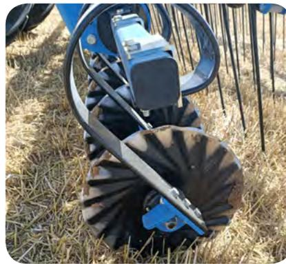
*Disques avec sécurité lame ressort*
