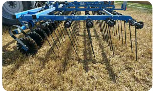
LIZA est une machine polyvalente, qui peut servir aussi bien à créer un faux semis, qu'à contrôler et détruire les adventices, lutter contre les nuisibles, mélanger la terre et la paille pour une bonne germination des graines... C'est un outil qui évite le passage de plusieurs machines, notamment en permettant la culture simplifiée.
