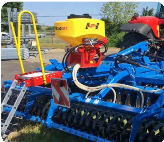
Il est possible d'ajouter un semoir APV (PS 200) à LIZA afin d'économiser du temps et une étape de travail supplémentaire. Ce semoir pneumatique permet d'implanter des couverts végétaux et d'épandre des graines d'herbe et de granulés similaires. Idéal pour la réalisation de sous-semis de prairie
