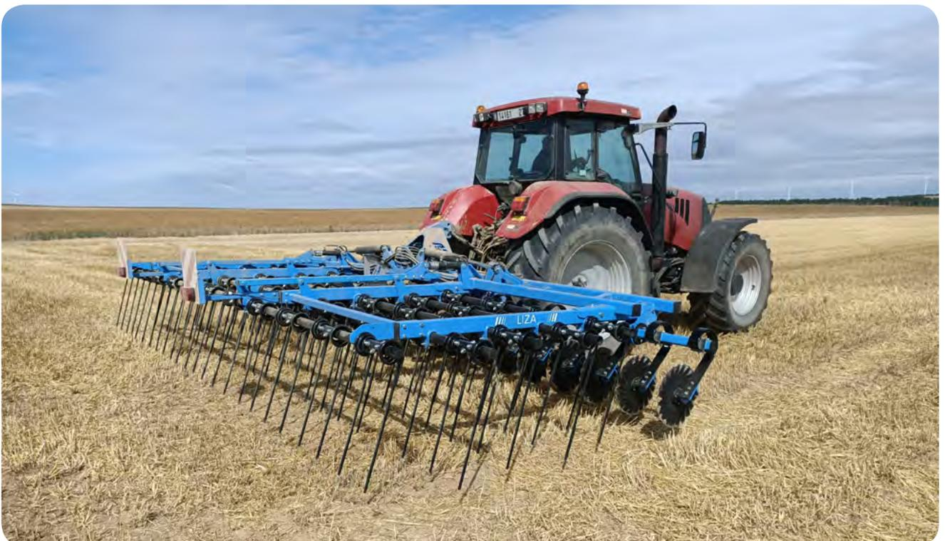
Le réglage hydraulique, à la fois des dents et des disques, permet d'obtenir une constance de travail, adaptée aux besoins du sol.
