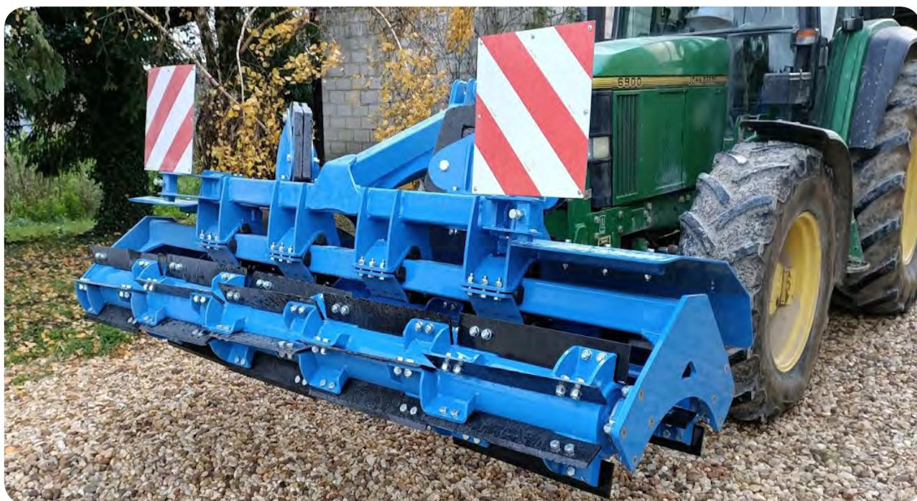
LILA est composée de lames de couteaux en **Hardox**. La solidité de l'Hardox garantit l'importante longévité de la machine. Ces couteaux sont boulonnés de manière individuelle aux rouleaux permettant leur remplacement rapide, facile et plus économique.
