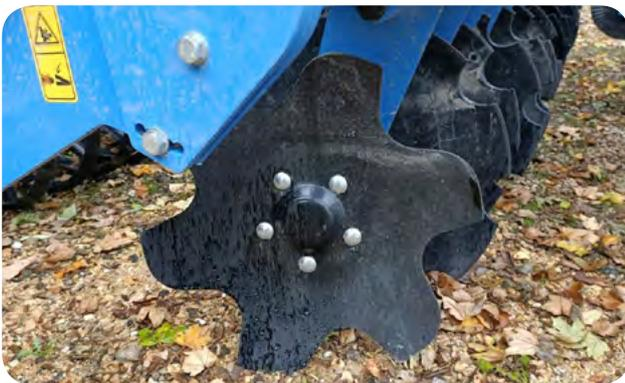
Grâce à l'espacement de 100 cm entre les 2 rangées de disques, LENKA ne risque pas le bourrage. Ce déchaumeur génère donc un travail de qualité et un gain de temps considérable.
