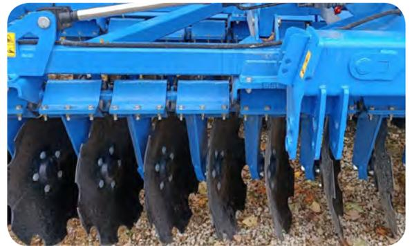
Grâce aux 4 vérins de repliage et au verrouillage hydraulique, LENKA n'est pas soumise aux oscillations aux extrémités de la machine. De plus, cela permet de maintenir et de stabiliser chaque rangée de disques.
