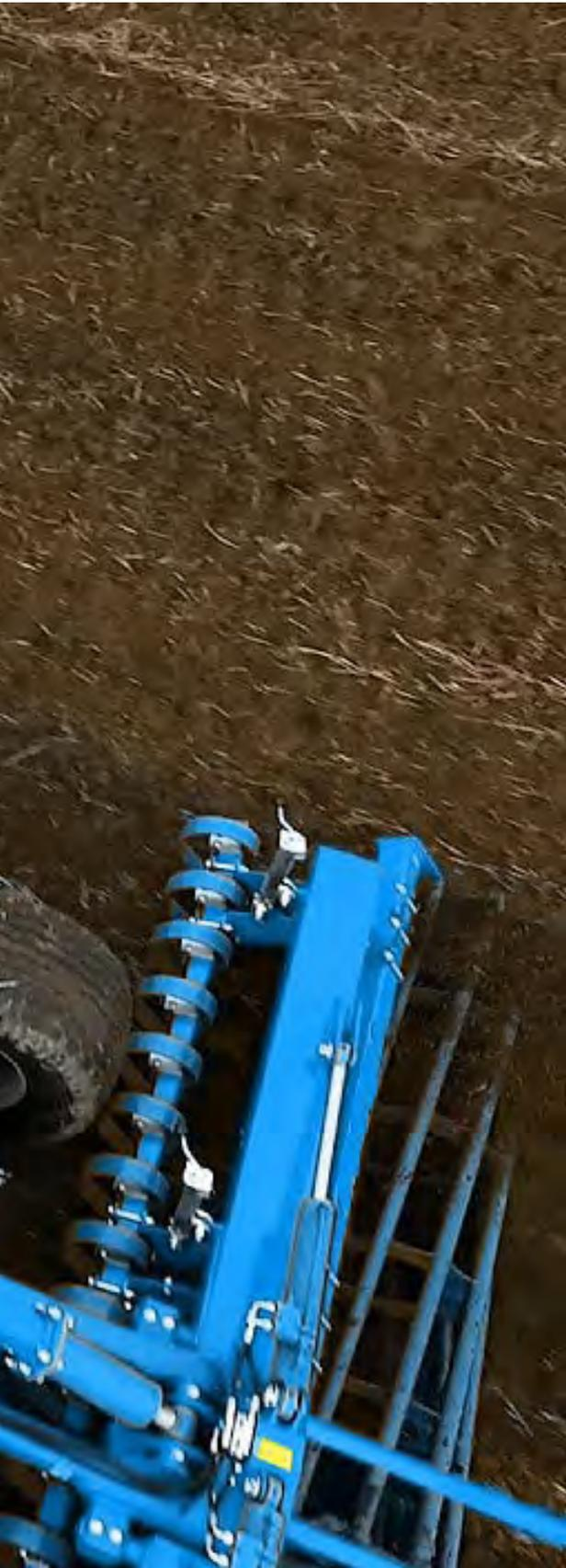
LENKA est un outil à disques indépendants conçus pour les travaux de déchaumage complexes. Il s'adapte aux conditions les plus difficiles et pénètre la terre sur 3 à 15 cm de profondeur.
