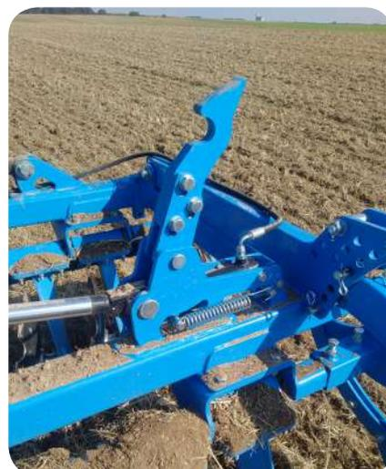
Verrouillage hydraulique au transport
