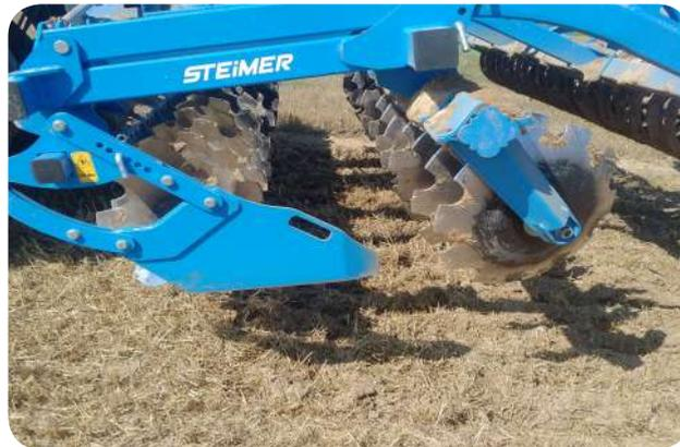
Le réglage hydraulique de profondeur, en option, offre un réel confort de travail. En effet, l'ajustement s'effectue de la cabine et permet d'obtenir un niveau de profondeur constant grâce à un clapet anti-retour.
