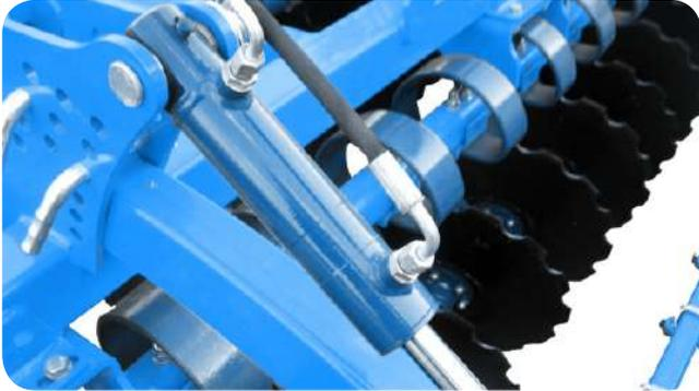
Un réglage hydraulique de profondeur, pour une régularité de travail.
