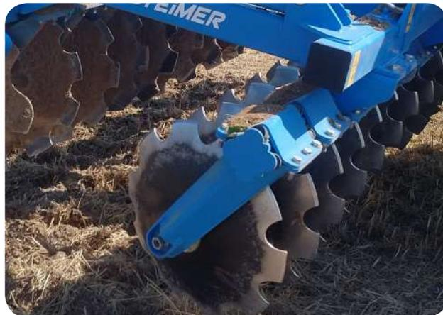
Le choix entre les deux types de sécurités des disques permet d'avoir une machine bien adaptée aux particularités du terrain. La sécurité à ressorts dispose d'un plus fort dégagement, ce qui convient notamment aux terres caillouteuses. La sécurité à boulons dispose d'un meilleur maintien et d'une pénétration plus facile dans les sols durs.
