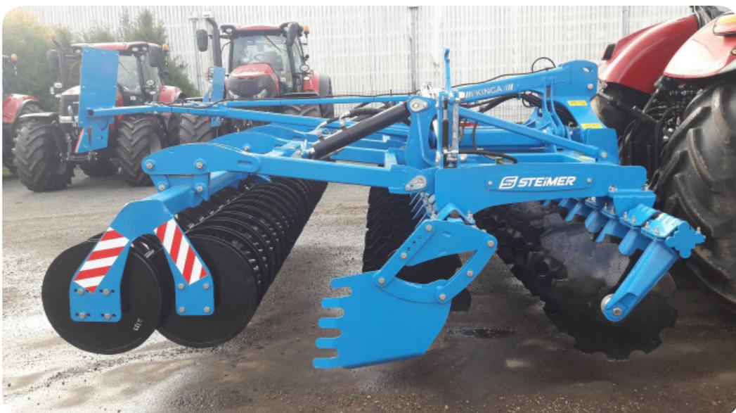
Grâce au verin de réglage hydraulique de série, il est facile et rapide d'ajuster la profondeur de travail.
