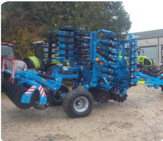
La version semi-portée comprend elle-aussi un châssis à repliage hydraulique ainsi qu'un verrouillage hydraulique au transport. L'essieu est composé de roues 550/50-17. Ce modèle est également équipé de garde-boue.
