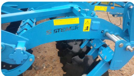
Le réglage des rangées de disques permet d'obtenir un travail homogène au fil du temps. Sur KINGA, il s'effectue simplement à l'aide de boulons à dévisser et à revisser en fonction du placement souhaité de la rangée. Pour la version semi portée, le réglage s'effectue à l'aide d'une manivelle fournie avec la machine.
