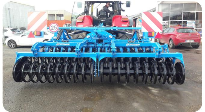
KINGA est sans conteste une machine qui garantit un réel confort d'utilisation. Grâce à une inclinaison des bras de 18°, l'angle d'attaque assure un mélange intensif de la terre tout en gardant une très bonne stabilité même après plusieurs passages. Cet angle permet par ailleurs une moindre consommation de carburant.
