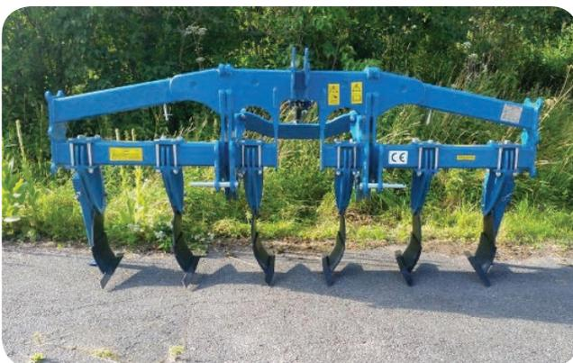
Grâce à la chape d'attelage, il est possible de régler l'agressivité des machines en fonction du type de sol.
