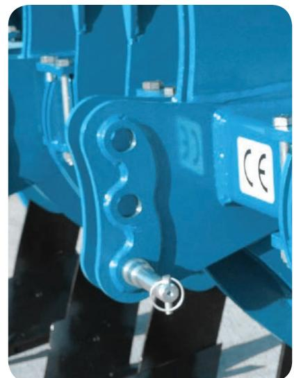
Les brides de fixations des dents permettent aisément de les enlever ou de les déplacer sur le châssis. SARA et EMA sont ainsi personnalisables selon les caractéristiques du terrain.
