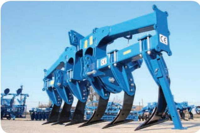
Les modèles de 3 mètres disposent d'une capacité d'extension. Ainsi, même après l'achat de la machine, il est possible d'en modifier la taille si besoin, pour passer à 4 mètres.
