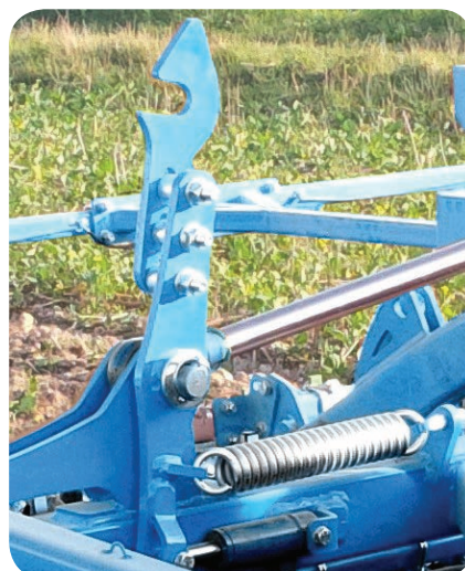
Verrouillage hydraulique au transport
