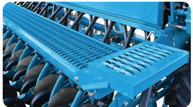
Passerelle de chargement
