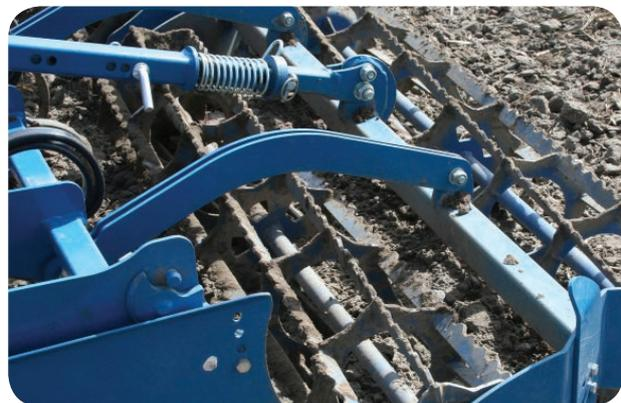
Le choix des dents ainsi que de l'accessoire à l'avant de la machine permet également d'adapter LENA au type de travail que l'on souhaite effectuer. Les deux types de dents réalisent un travail plus ou moins profond, tandis que la planche de nivellement et le rouleau à barres s'utilisent sur des sols aux caractéristiques différentes (labour motteux, sol battant etc.).
