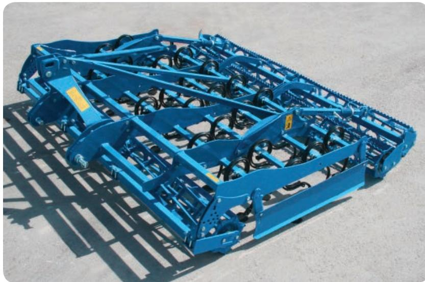
Le modèle repliable possède les mêmes équipements, à l'exception du châssis à repliage hydraulique et du verrouillage hydraulique au transport.
