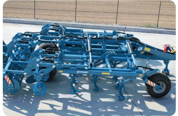
Chassis repliable semi porté avec essieu central, versions 5,00 m et 6,00 m
