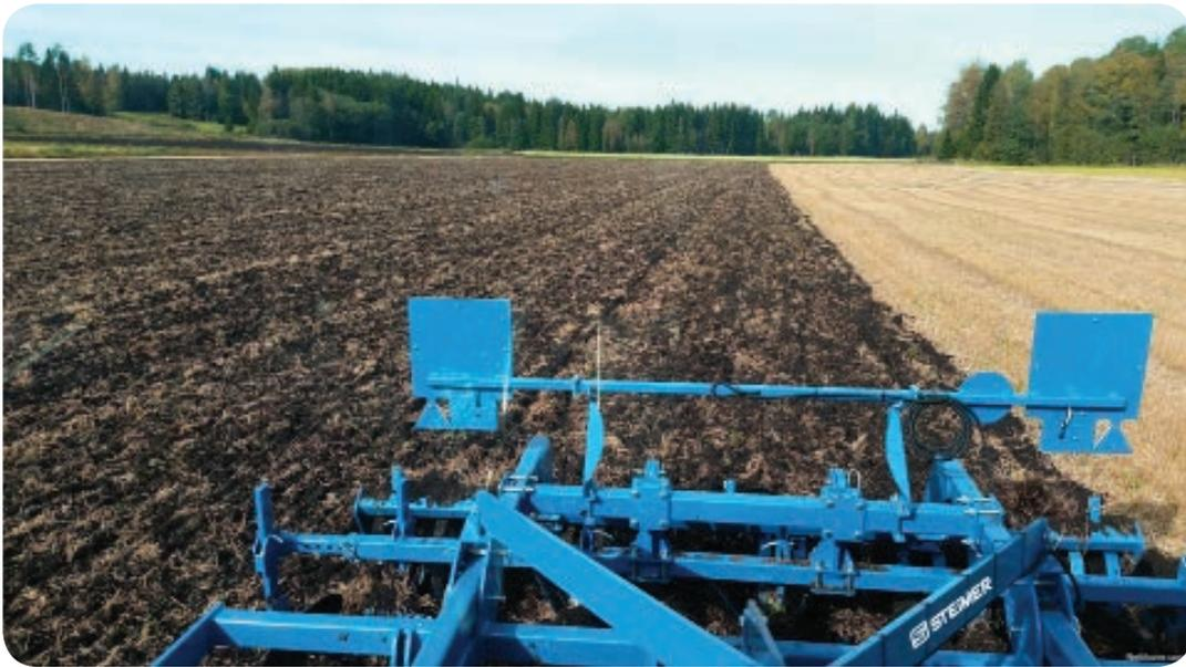
Le modèle semi-porté dispose de roues de  $\varnothing 520/50-17$ , soit entre les disques et le rouleau (5,00 et 6,00 m) soit derrière le rouleau (4,00 et 4,50 m). Les roues de jauges en option sont très utiles pour une profondeur de travail constante sur une surface irrégulière.
