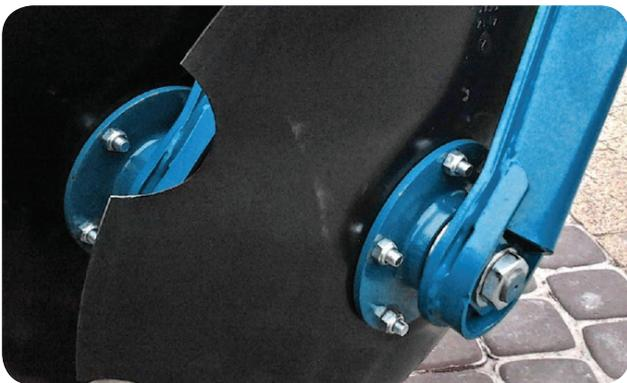
Grâce à l'espacement de 100 cm entre les 2 rangées de disques, LENKA ne risque pas le bourrage.
