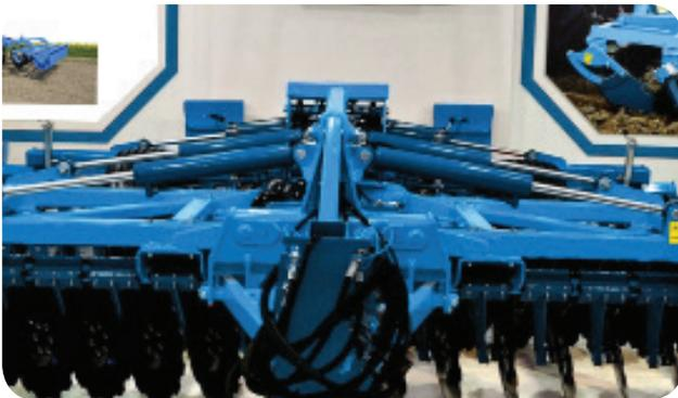
Afin de déchaumer confortablement sur tous les types de sols, sans être endommagée, LENKA dispose d'un système hydraulique d'amortissement. La durée de vie de la machine est ainsi accrue et la vitesse de travail plus importante.
