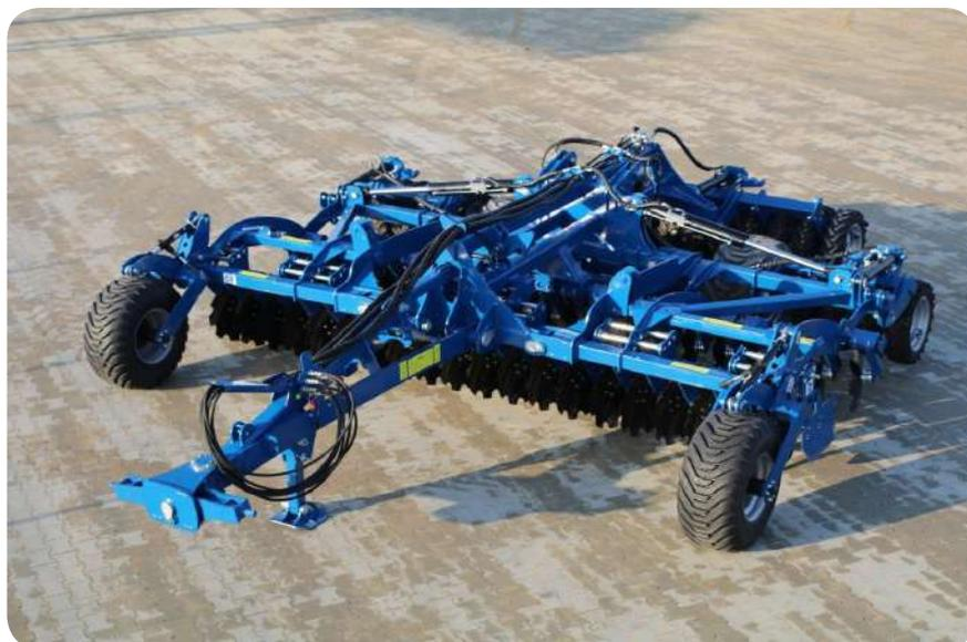
Grâce au verin de réglage hydraulique de série, il est facile et rapide d'ajuster la profondeur de travail.
