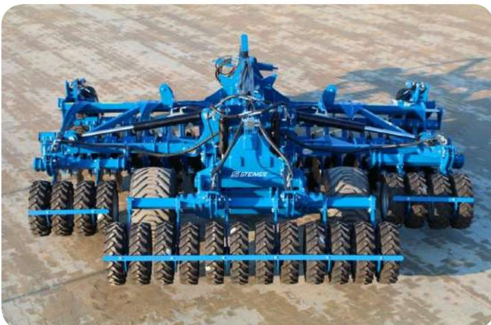
La version semi-portée comprend elle-aussi un châssis à repliage hydraulique ainsi qu'un verrouillage hydraulique au transport. L'essieu est composé de roues 550/50-17. Ce modèle est également équipé de garde-boue.
