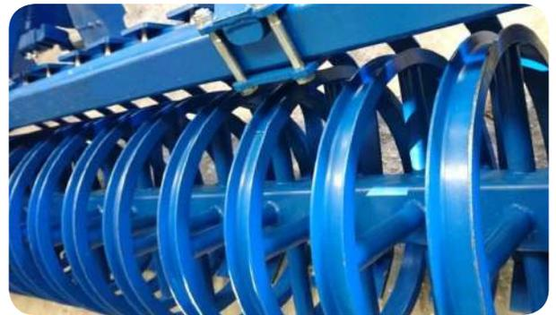
KINGA est sans conteste une machine qui garantit un réel confort d'utilisation. Grâce à une inclinaison des bras de 18°, l'angle d'attaque assure un mélange intensif de la terre tout en gardant une très bonne stabilité même après plusieurs passages. Cet angle permet par ailleurs une moindre consommation de carburant.
