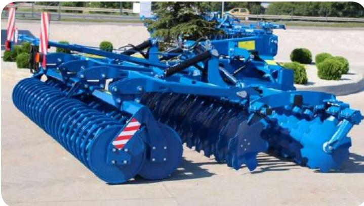
Le modèle porté repliable dispose en plus d'un châssis hydraulique et d'un verrouillage hydraulique au transport.
