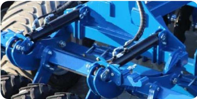
Le réglage des rangées de disques permet d'obtenir un travail homogène au fil du temps. Sur KINGA, il s'effectue simplement à l'aide de boulons à dévisser et à revisser en fonction du placement souhaité de la rangée.
