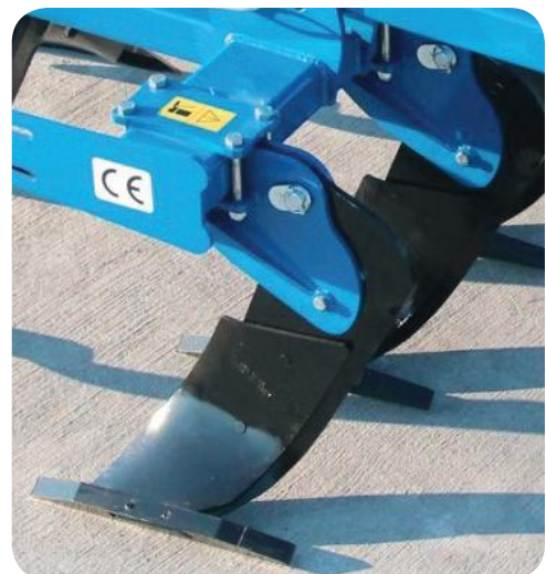
Protection par boulon
