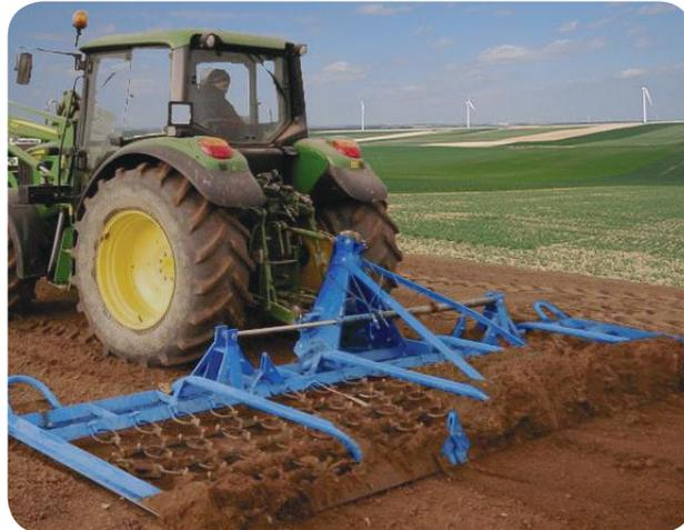
Avec son système de fixation, cette machine permet un démontage et un montage des bagues de manière simple et rapide. Il est donc facile de changer la disposition des chaînes selon le résultat souhaité (côté lisse ou côté pointes).
