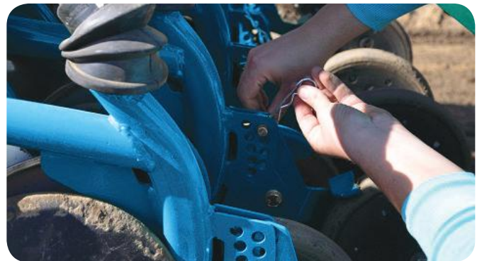
Réglage des roues plumbeuses
