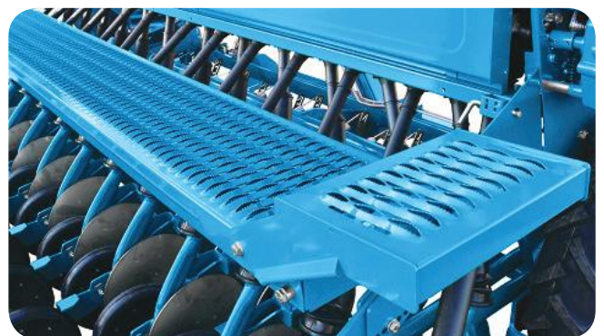
Passerelle de chargement
