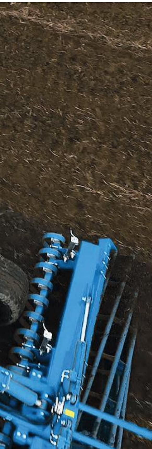
LENKA est un outil à disques indépendants conçus pour les travaux de déchaumage complexes. Il s'adapte aux conditions les plus difficiles et pénètre la terre sur 3 à 15 cm de profondeur.
