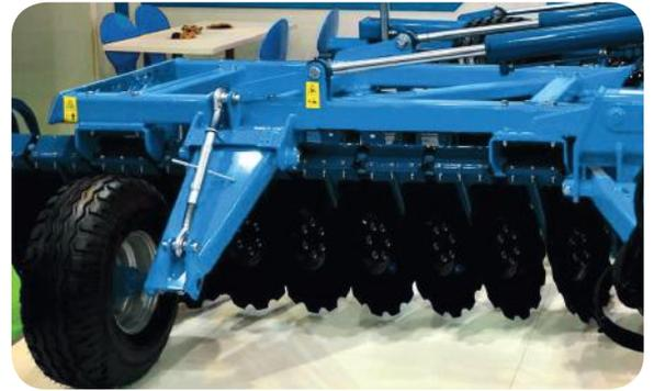
Grâce aux 4 vérins de repliage, LENKA n'est pas soumise aux oscillations aux extrémités de la machine. De plus, cela permet de maintenir et de stabiliser chaque rangée de disques.
